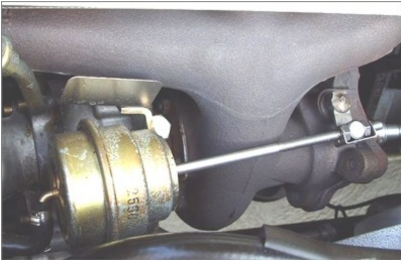
Actuador wastegate
