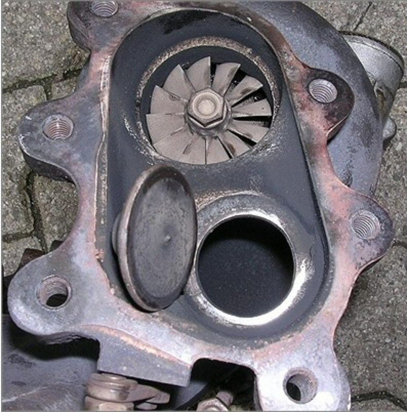
Actuador wastegate
